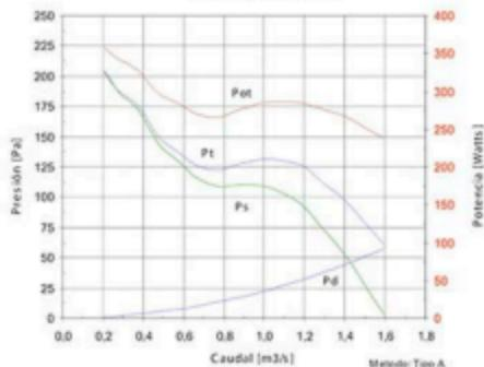
Las siguientes curvas corresponden a las prestaciones de las hélices standard helicoidales de P (polipropileno y fibra de vidrio). Para información y curvas de prestaciones de palas de chapa (C) con centro de aluminio , consultar .
