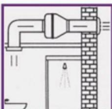
Intercalado de un conducto.
