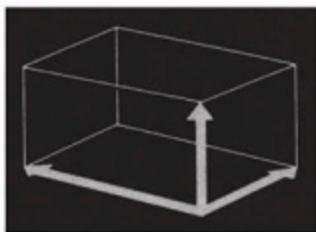
Imaginemos un bar de 4 m de ancho, 7m de largo y 3 m de alto. Para calcular el caudal de aire necesario para ventilarlo, primeramente se calcula la cubicación:  $4 \times 7 \times 3 = 84 \text{ m}^3$ .
