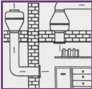
Al inicio de un conducto. At the beginning of a tube
